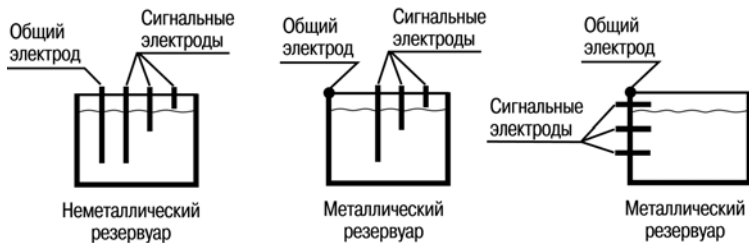
Рисунок 5.4 – Примеры установки кондуктометрических зондов
